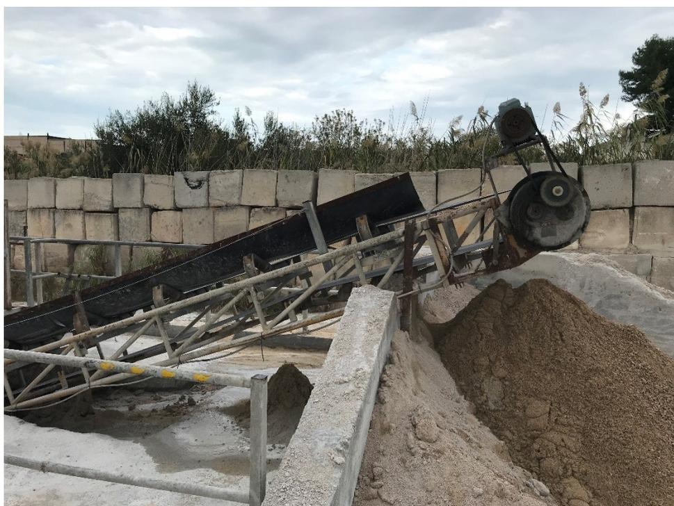
Figura 98 Nastro trasportatore fanghi
