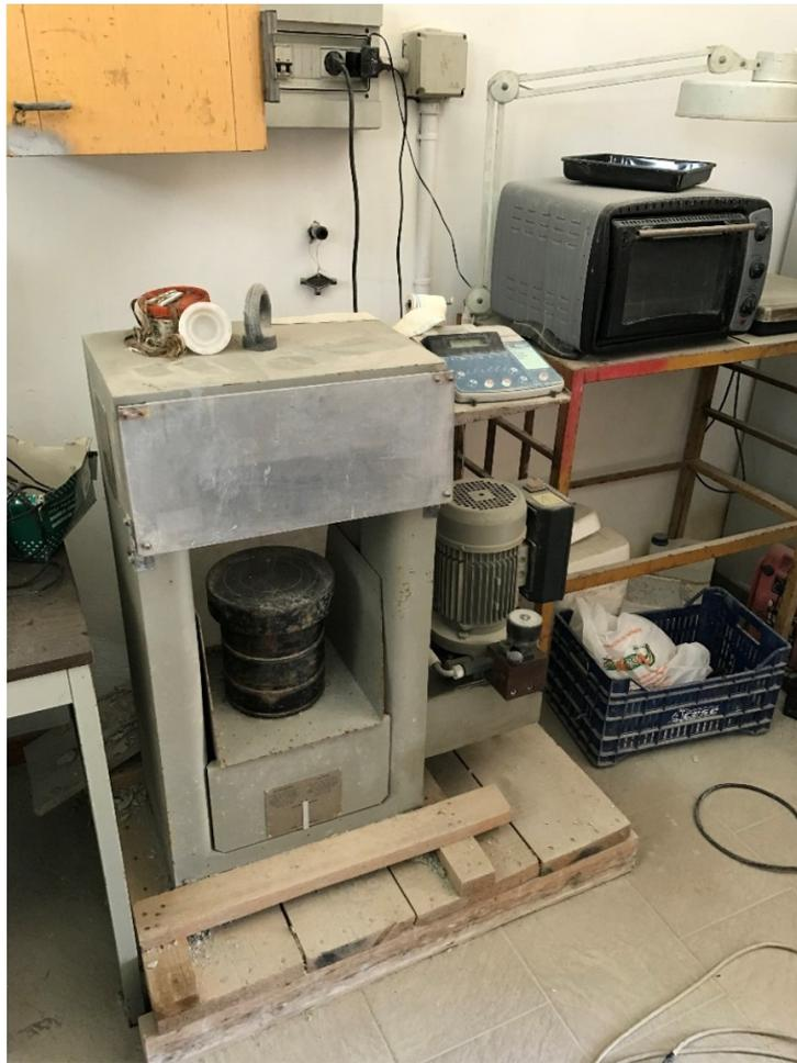
Figura 99 Impianto per prova compressione provini cls
